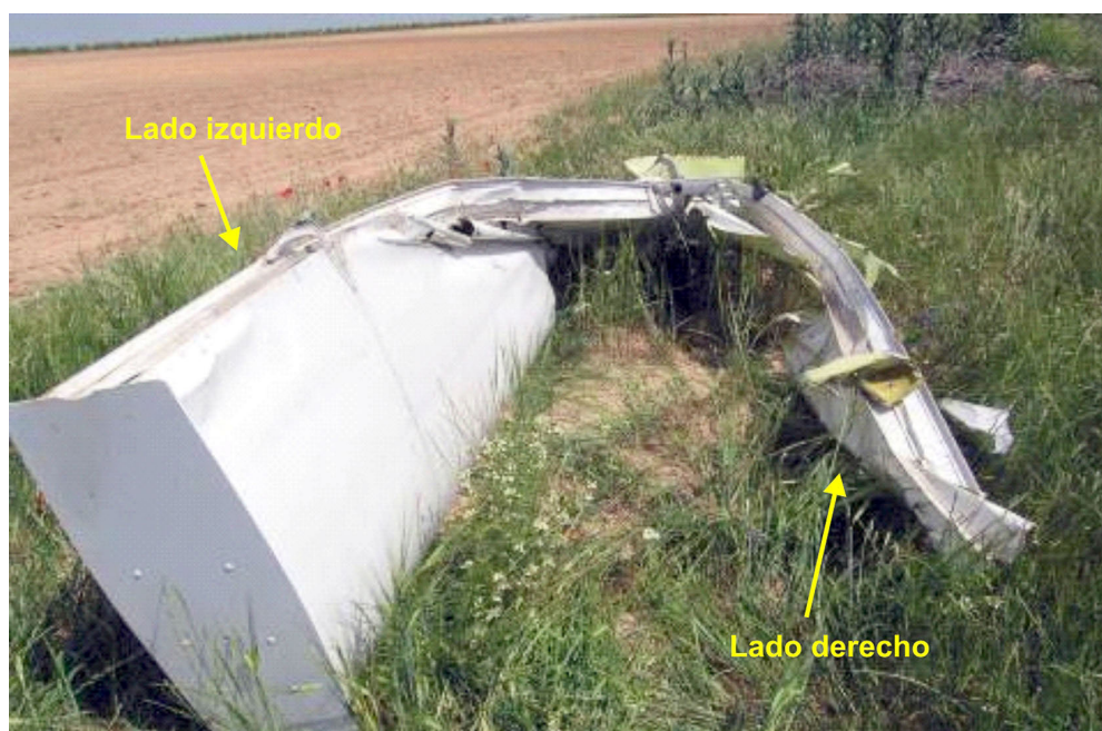
Figura 13. Fotografía del estabilizador horizontal
