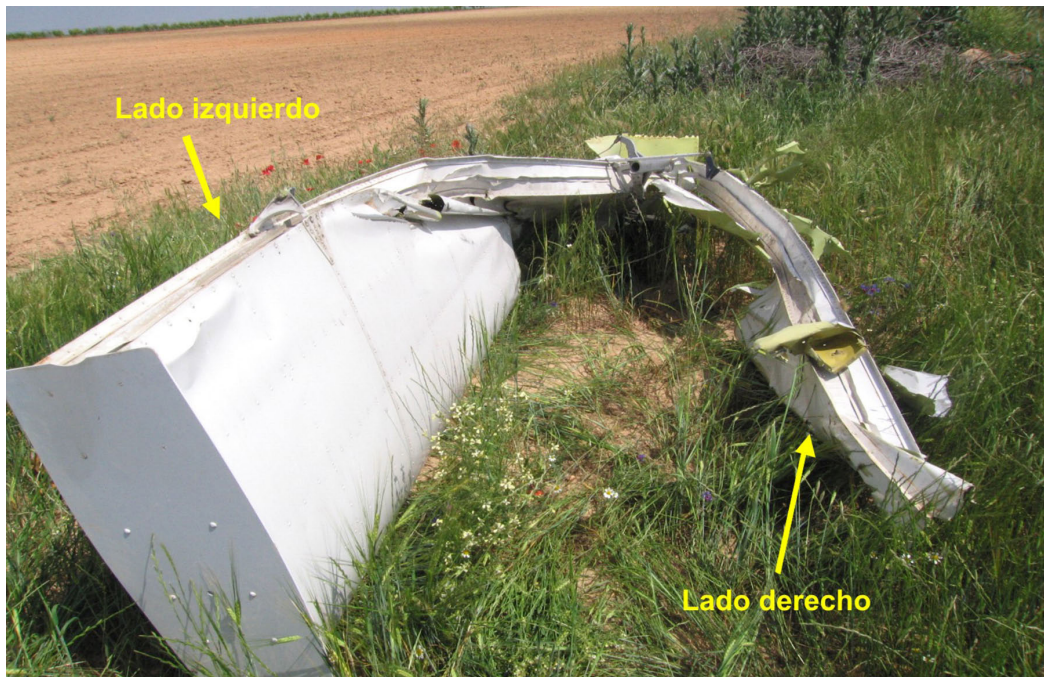
Figura 11. Fotografía del estabilizador horizontal
