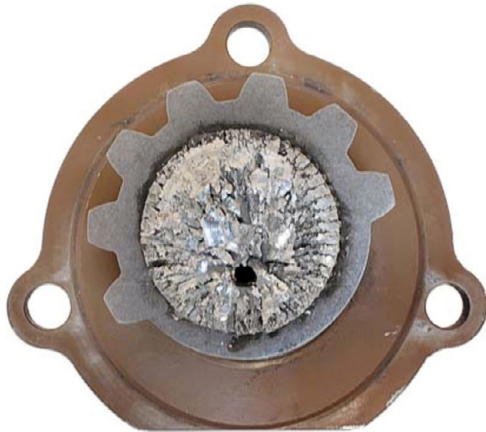
Figura 4. Sección de rotura del eje
