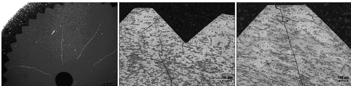
Figura 6. Corte transversal próximo a la zona de rotura. Detalles de las grietas
