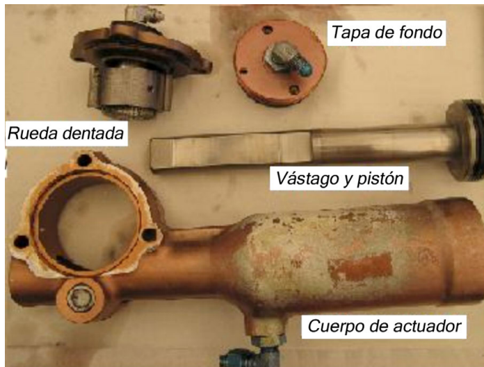
Figura 3. Despiece del actuador de tren
