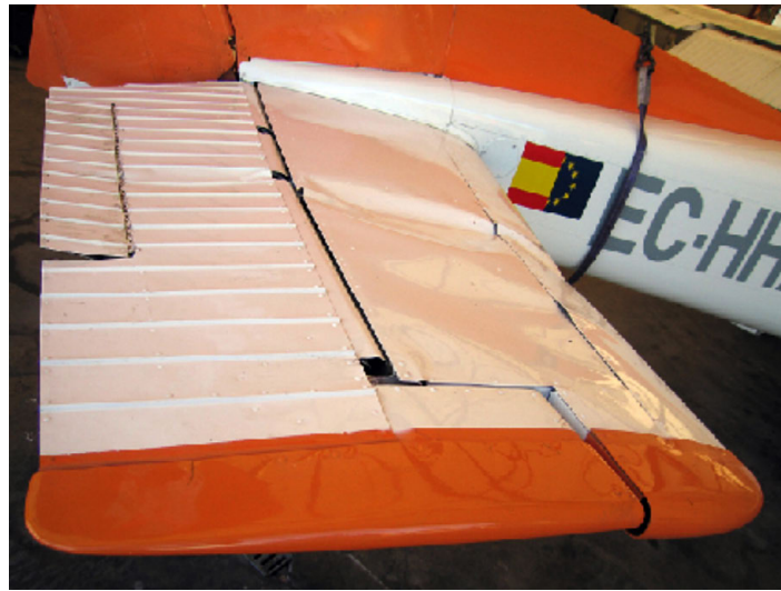
Figura 1. Daños en estabilizador derecho
