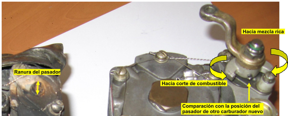
Figura 9. Estado de la mezcla en carburador izquierdo
