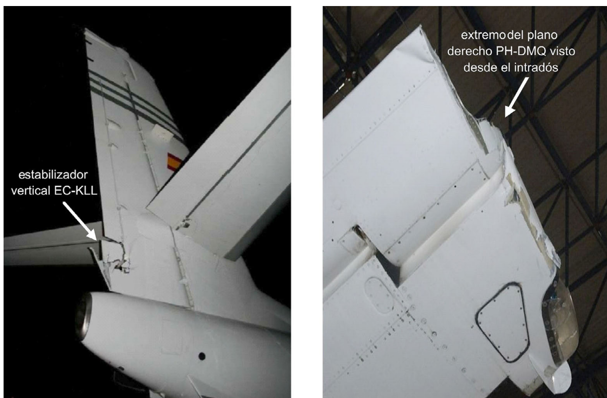
Figura 1. Daños en las aeronaves EC-KLL y PH-DMQ
