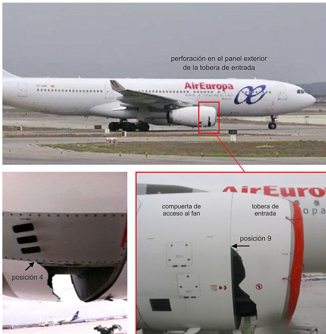
Figura 1. Aeronave tras el incidente (vista lateral del motor número 2)
