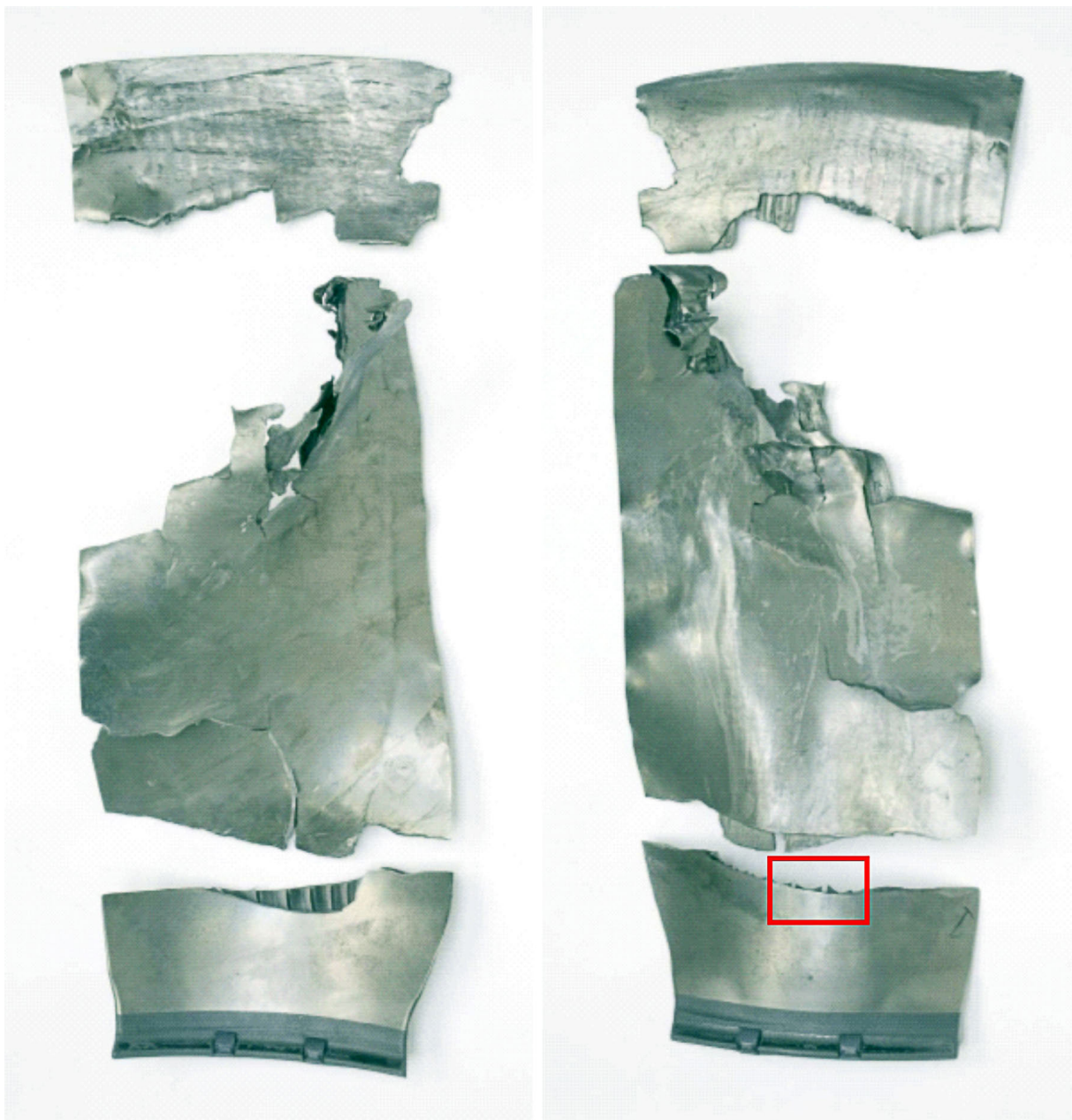
Figura 6. Reconstrucción del álabe (izquierda-panel de presión y derecha-panel de succión)
