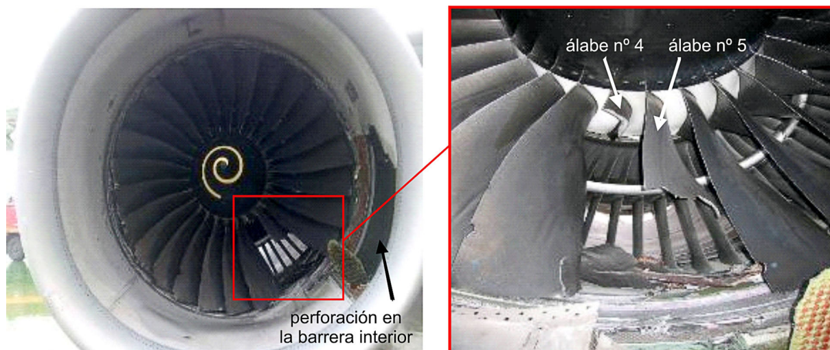
Figura 2. Aeronave tras el incidente (vista frontal del motor número 2)
