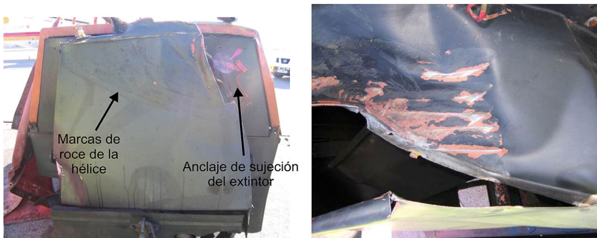
Figura 2. Fotografías del GPU. A la izquierda parte trasera con marcas de roce de la hélice y a la derecha detalle de marcas de impacto de pala
