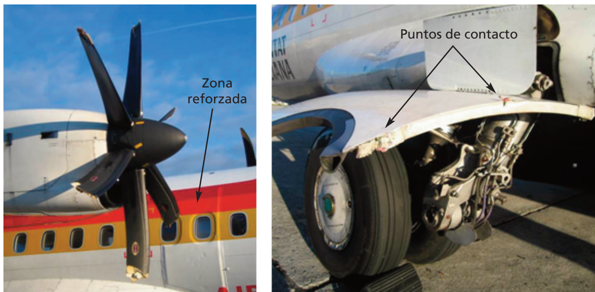
Figura 1. Fotografías de los daños en la hélice y en la compuerta de la pata derecha del tren de aterrizaje principal.
