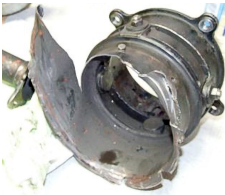
Figura 13. «Mounting cone» roto. Se puede apreciar la rotura producida en él por los fragmentos de acoplamiento flexible proyectados radialmente
