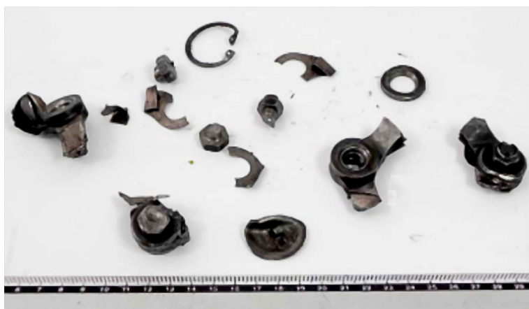
Figura 16. Trozos del acoplamiento flexible destrozado que unía el eje que sale de la turbina con el intermedio
