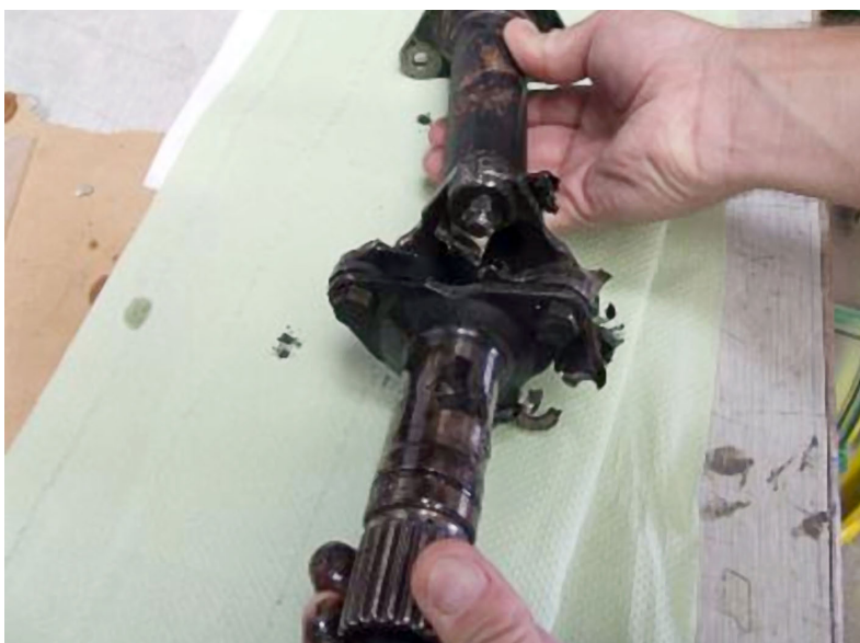
Figura 12. Acoplamiento flexible parcialmente roto entre el eje intermedio con el que entra en la caja combinada
