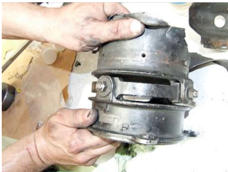
Figura 14. «Mounting cone» roto. Se puede apreciar en detalle el acoplamiento tipo Cardan
