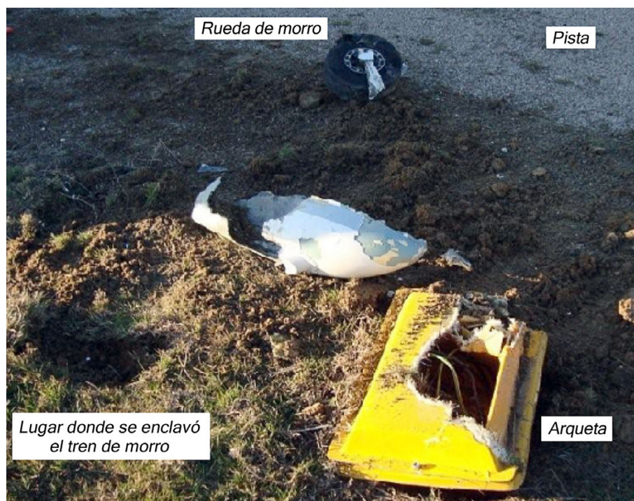
Figura 1. Daños producidos en y por el tren de morro
