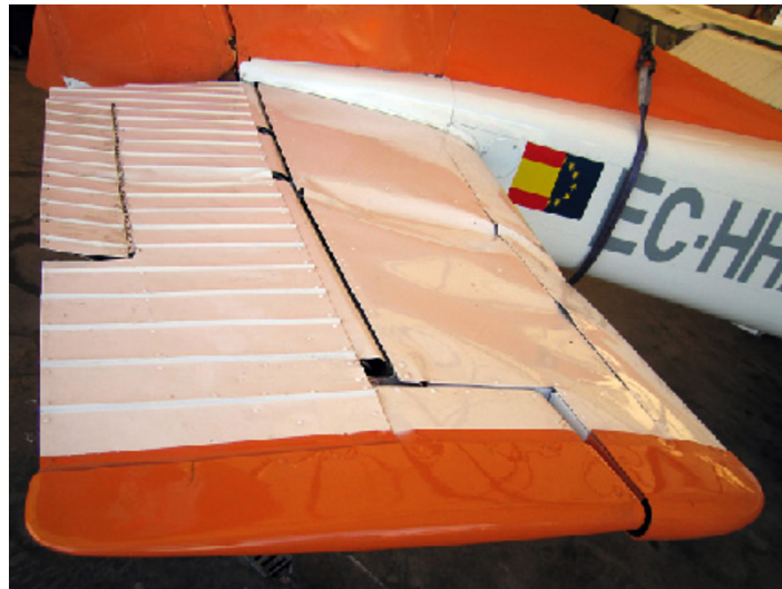
Figura 1. Daños en estabilizador derecho
