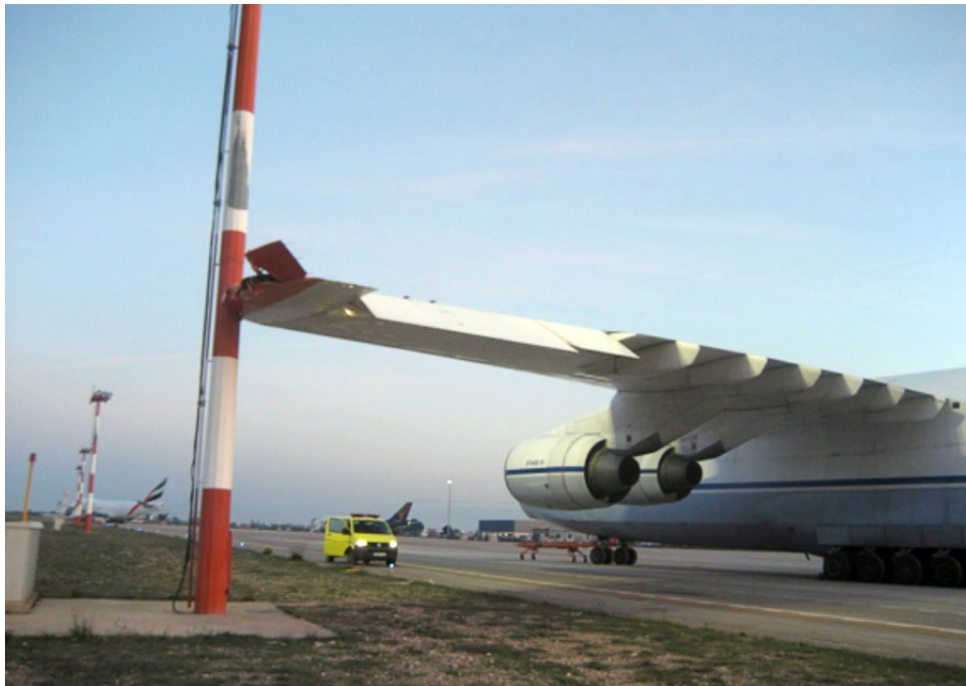
Figura 2. Daños sufridos por la aeronave
