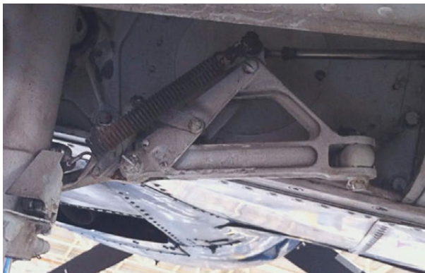
Estado del sistema de tren izquierdo sin bloquear
