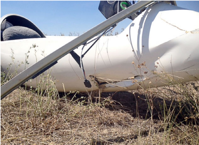
Figura 2. Daños en la zona delantera inferior del fuselaje
