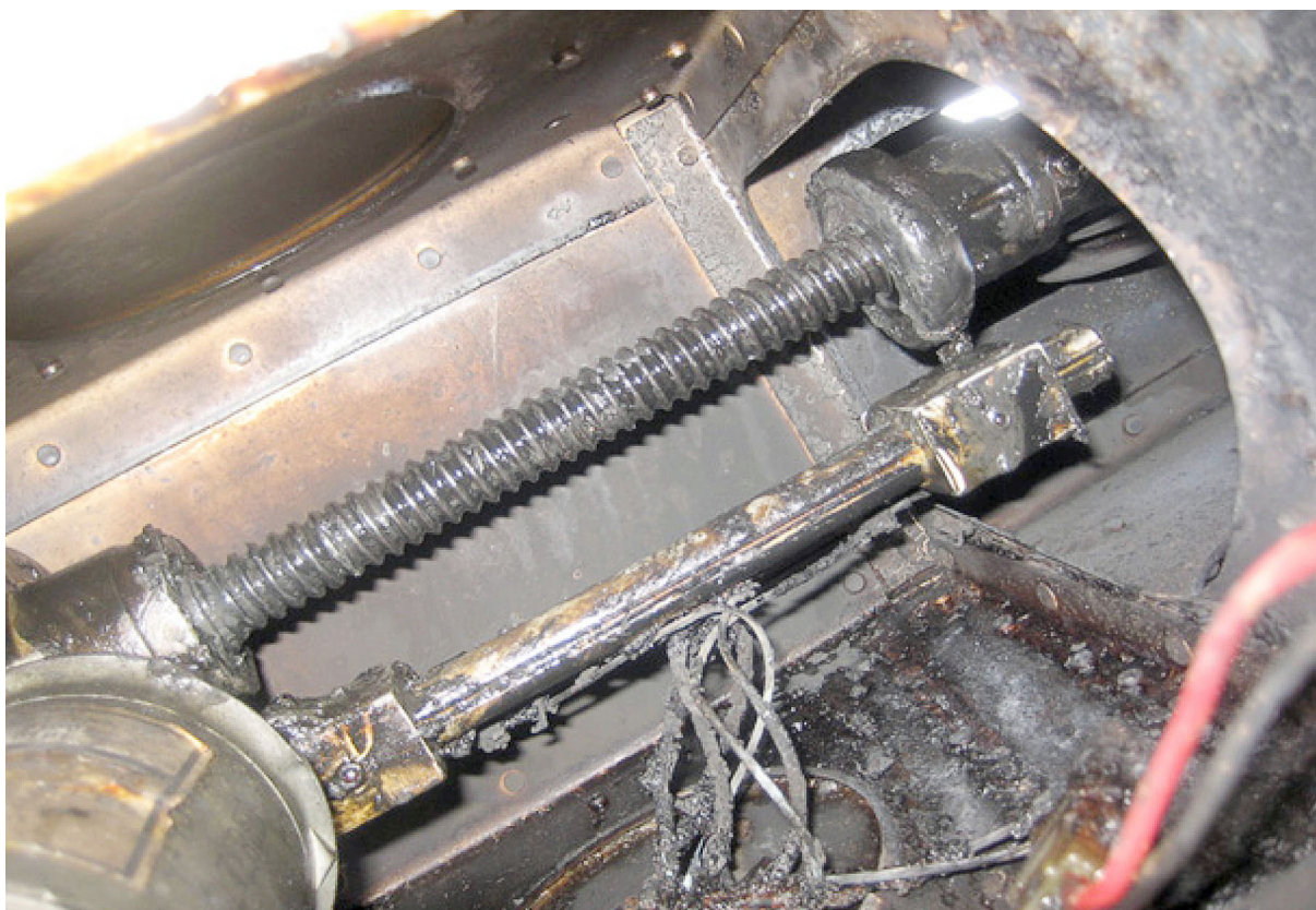
Figura 5. Tubo de actuación y collar de actuación de micros en posición totalmente desplegados
