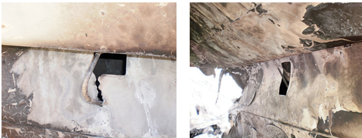
Figura 4. Biela de actuación del flap izquierdo deformada por el impacto y la del lado derecho sin deformaciones
