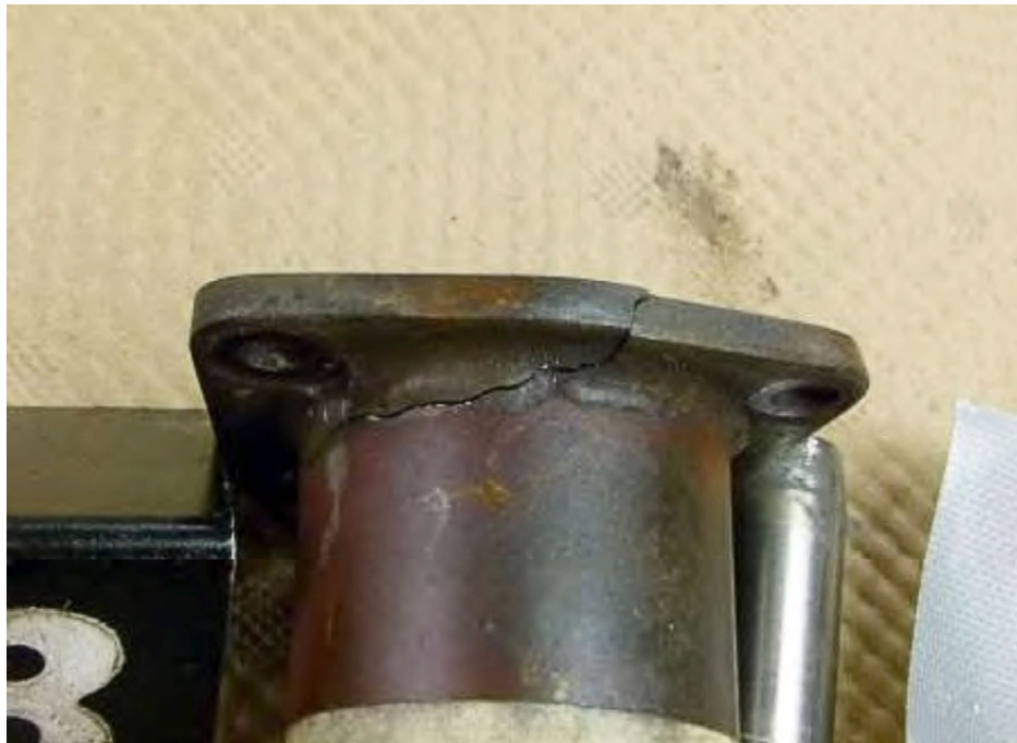
Figura 4. Grietas en boquilla de escape n.º 3, con signos de sobrecalentamiento
