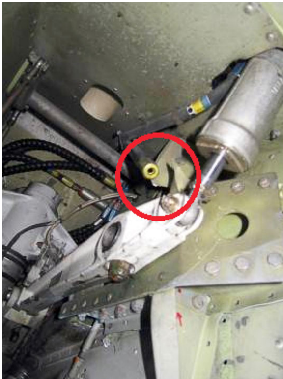
Figura 6. Retorno de la línea hidráulica que alimenta el actuador
