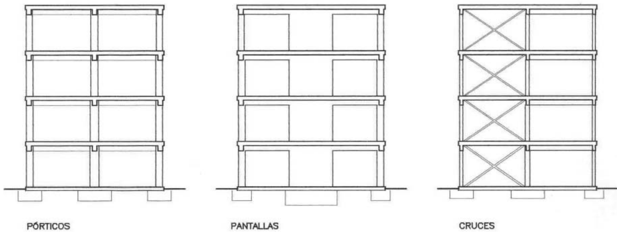
Figura 3.5.- Ejemplos de organizaciones estructurales que permiten un valor del coeficiente de comportamiento por ductilidad \mu = 3 .
