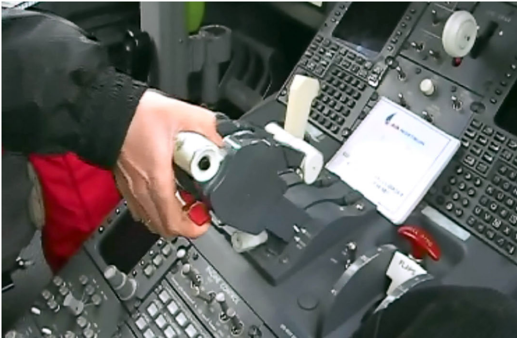
Figura 5. Actuación de la palanca de la posición de IDLE a SHUT OFF
