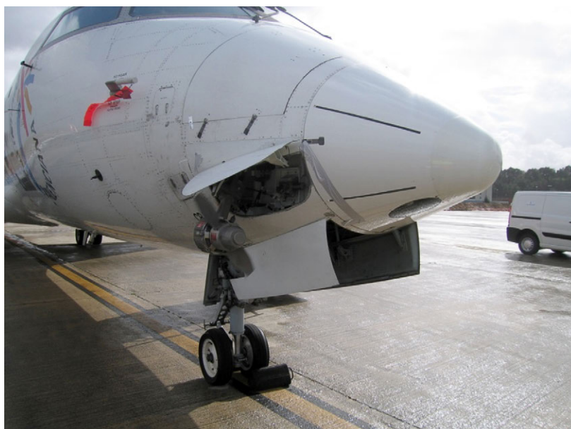
Figura 1. Aeronave con el ADG desplegado después del aterrizaje
