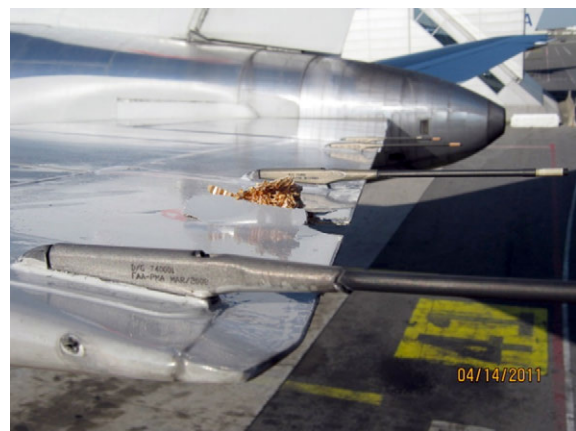
Figura 2. Daños en el estabilizador del B767
