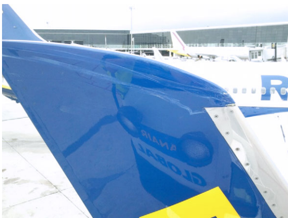
Figura 1. Daños en el winglet del B737
