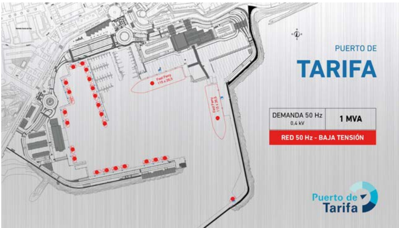
Conexión a la red eléctrica de distribución para OPS del Puerto de Tarifa. Fuente: Autoridad Portuaria de la Bahía de Algeciras.
