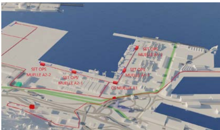
2ª acometida y 4 SET OPS, canalización y tomas para buques portacontenedores. Fuente: Autoridad Portuaria de Bilbao.
