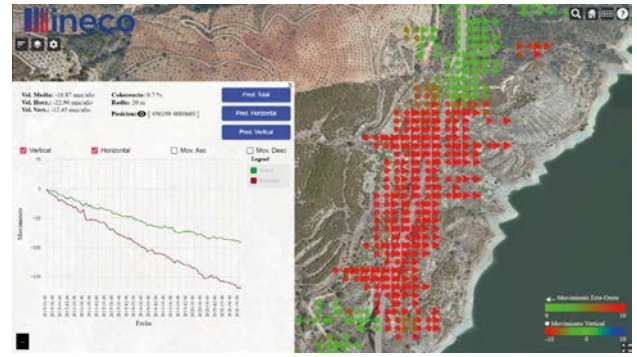
Desplazamiento de la ladera oeste del embalse de Rules. Las flechas representan el desplazamiento en la dirección E-O, y los puntos el movimiento vertical. Fuente: InecoSAR
