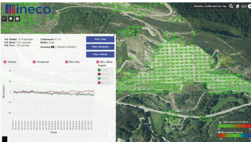
Desplazamiento horizontal y vertical del talud de Trabadelo, en el que no se aprecian movimientos significativos.
