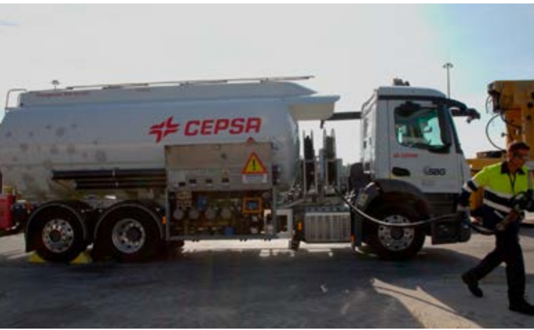
Operación de repostaje mediante un camión cisterna.
