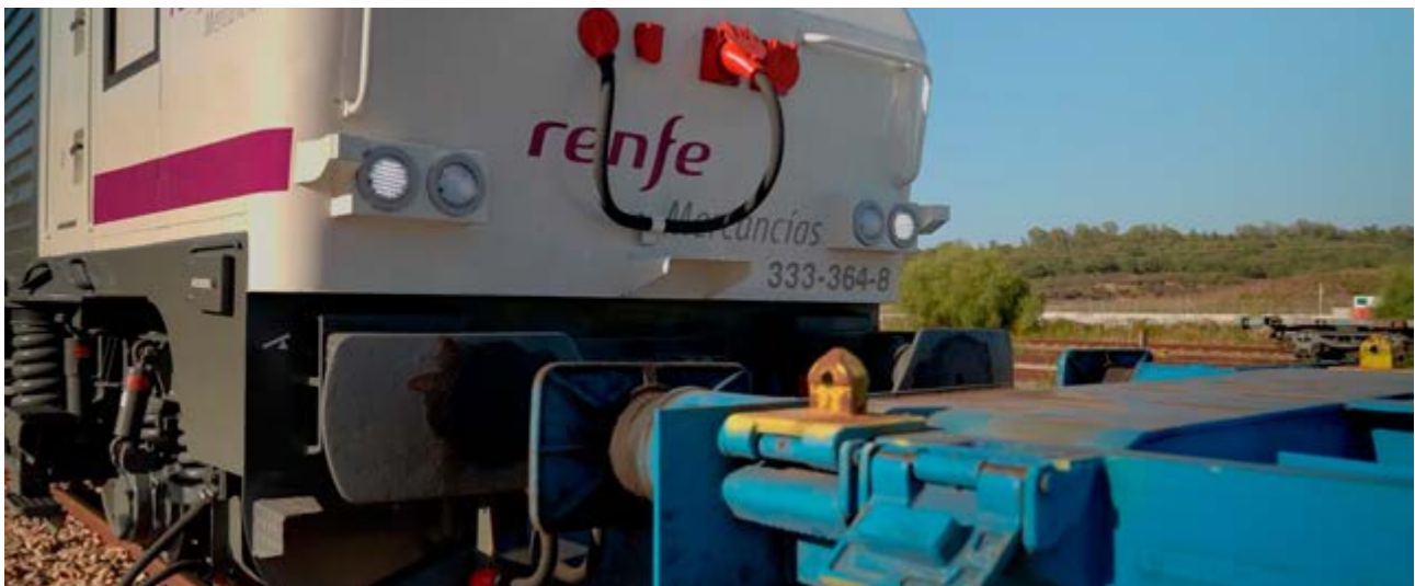
Acoplamiento de la locomotora de Renfe Mercancías a uno de los vagones.
