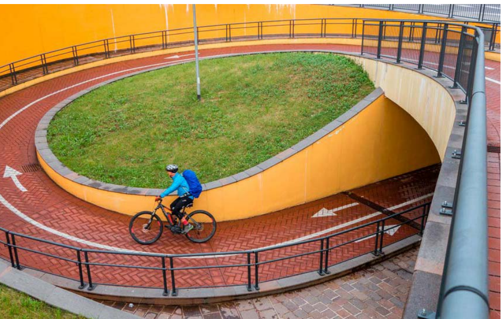
Las pendientes constituyen un elemento esencial en el diseño de pasos a distinto nivel.
