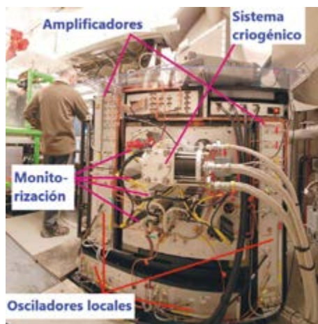
El receptor EMIR de cuatro bandas permite cubrir desde 70 hasta 370 gigahercios. A la derecha, su interior durante el montaje en laboratorio.
