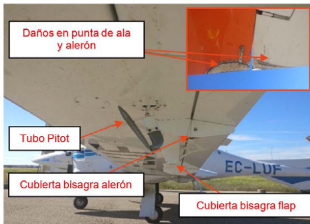
Fotografía 6. Daños en punta de ala derecha
