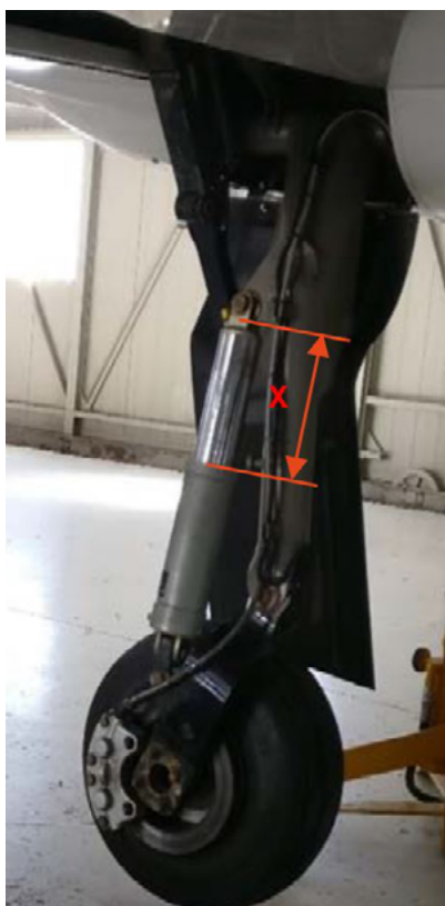
Fotografía 10. Dimensión "x" de extensión del amortiguador
