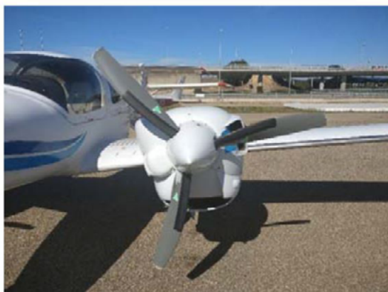
Fotografía 3. Daños en hélice de motor izquierdo
