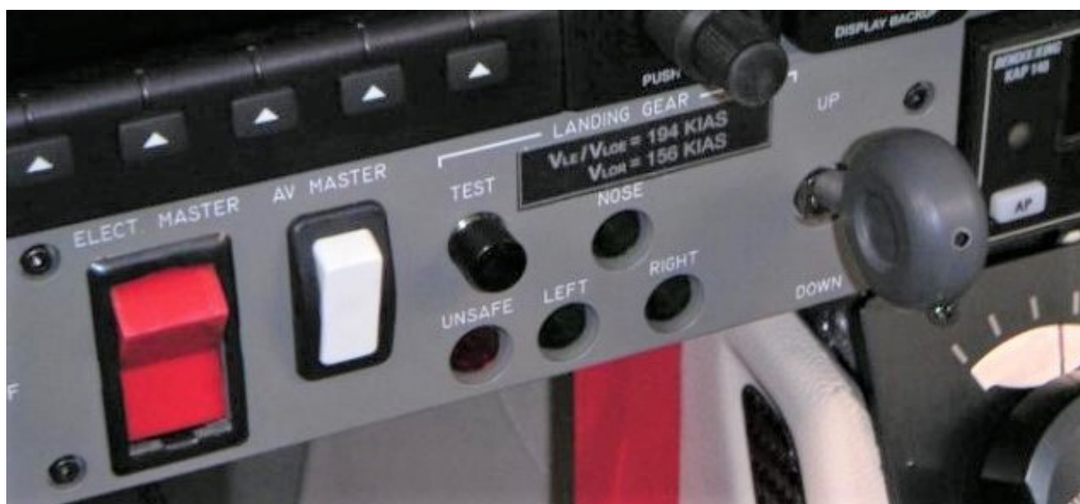
Fotografía 11. Localización en cabina de los indicadores del tren de aterrizaje
