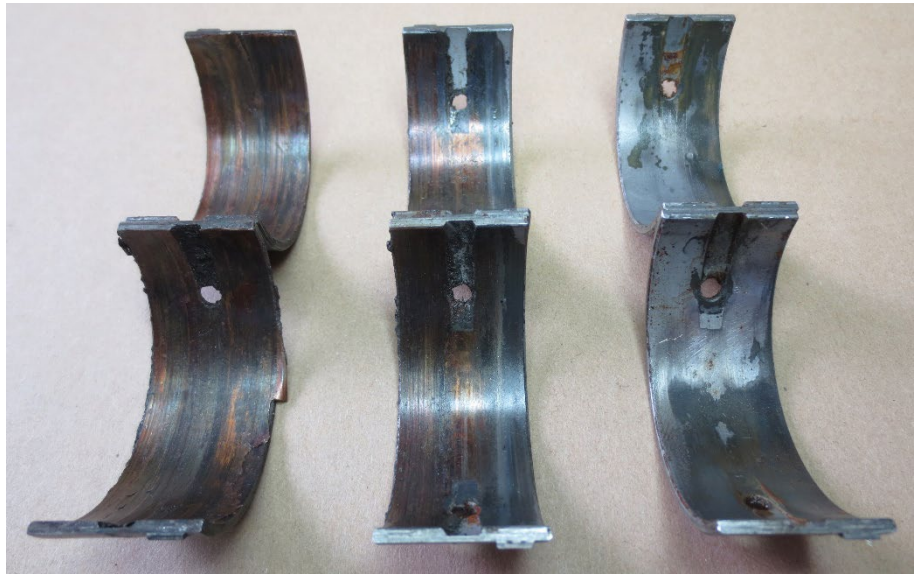
Figura 10. Fotografía de los cojinetes del cigüeñal (izquierda apoyo delantero, centro apoyo central y derecha apoyo trasero)
