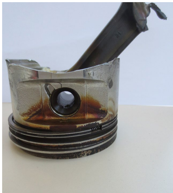
Figura 9. Fotografía de la muñequilla del cilindro nº1, con restos de la biela (izquierda) y del pistón nº1 con el otro fragmento de la biela (derecha)
