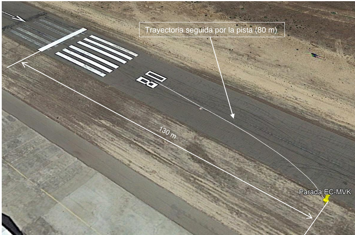
Figura 3: Trayectoria aproximada seguida por la aeronave al arrastrar por la pista tras el segundo rebote.
