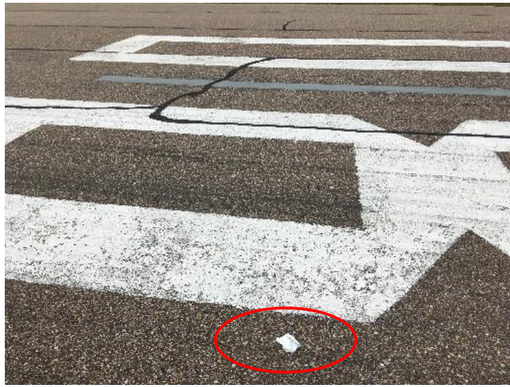
Figura 4: Trozo del carenado de la pata de morro
