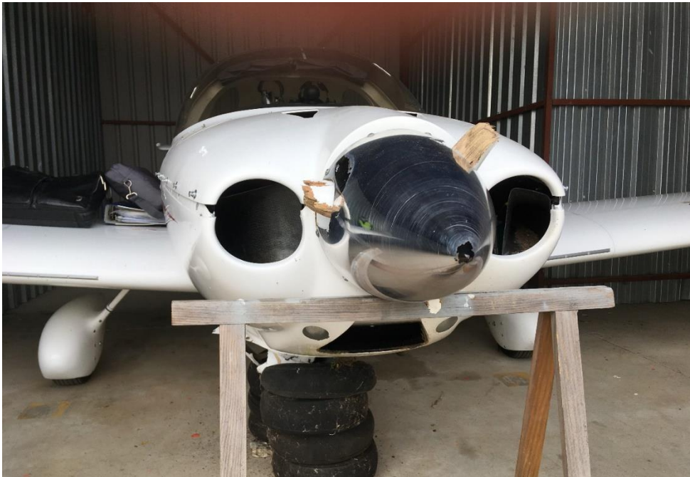
Figura 7: daños en las palas de la hélice
