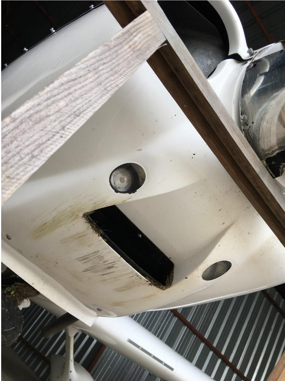
Figura 11: daños en la carena de la parte inferior del motor:
