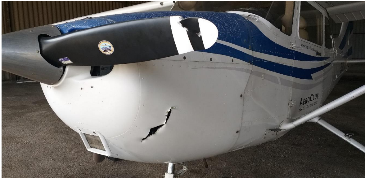
Fig. 5: Daños en la hélice y en el carenado del motor.
