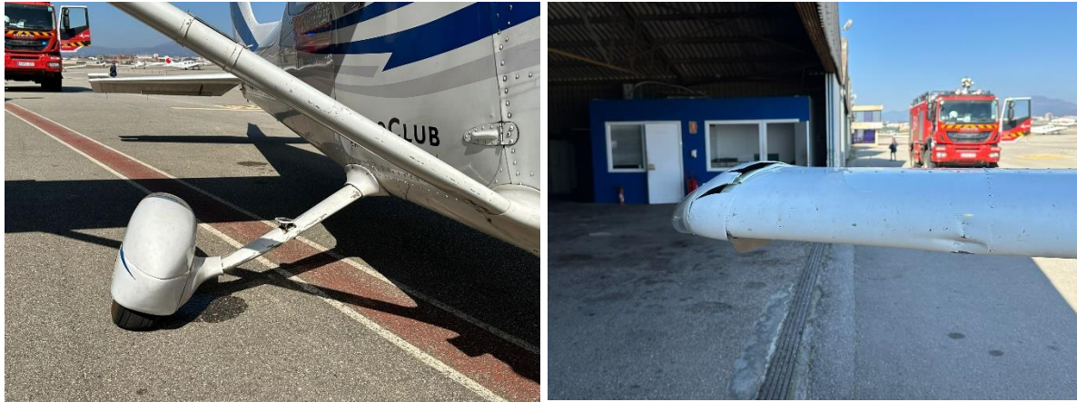
Fig. 4: Daños en el tren de aterrizaje y en la punta del semi ala derecha.
