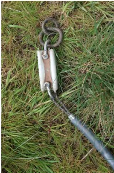
Fig. 7: Gancho a la aeronave y fusible marrón de 850 kg
