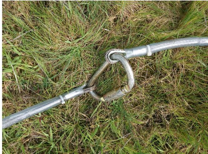
Fig. 8: Unión de cables mediante mosquetón
