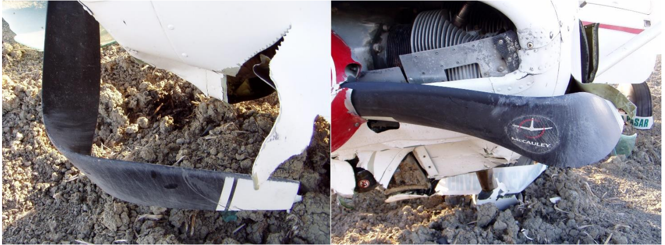
Figura 5. Daños en hélice
