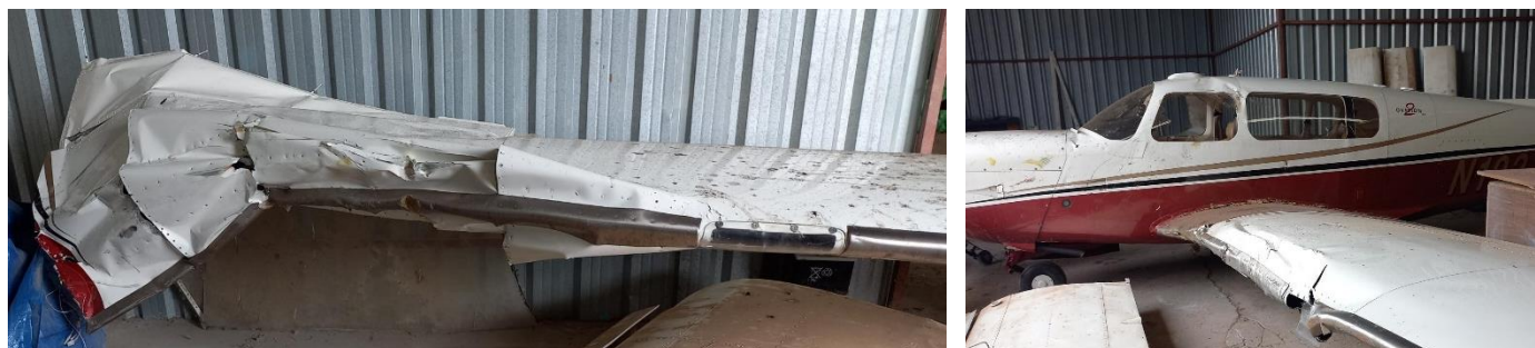
Figura 6. Daños en el ala
