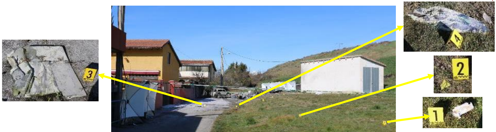
Ilustración 4 A la izquierda, la punta del plano izquierdo (número 3) y a la derecha, parte del cono de cola, número 4
