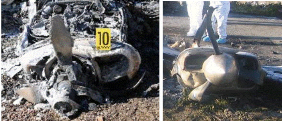
Ilustración 6: Fotografías de las palas de la hélice del motor derecho (a la izquierda) y del motor izquierdo (a la derecha)
