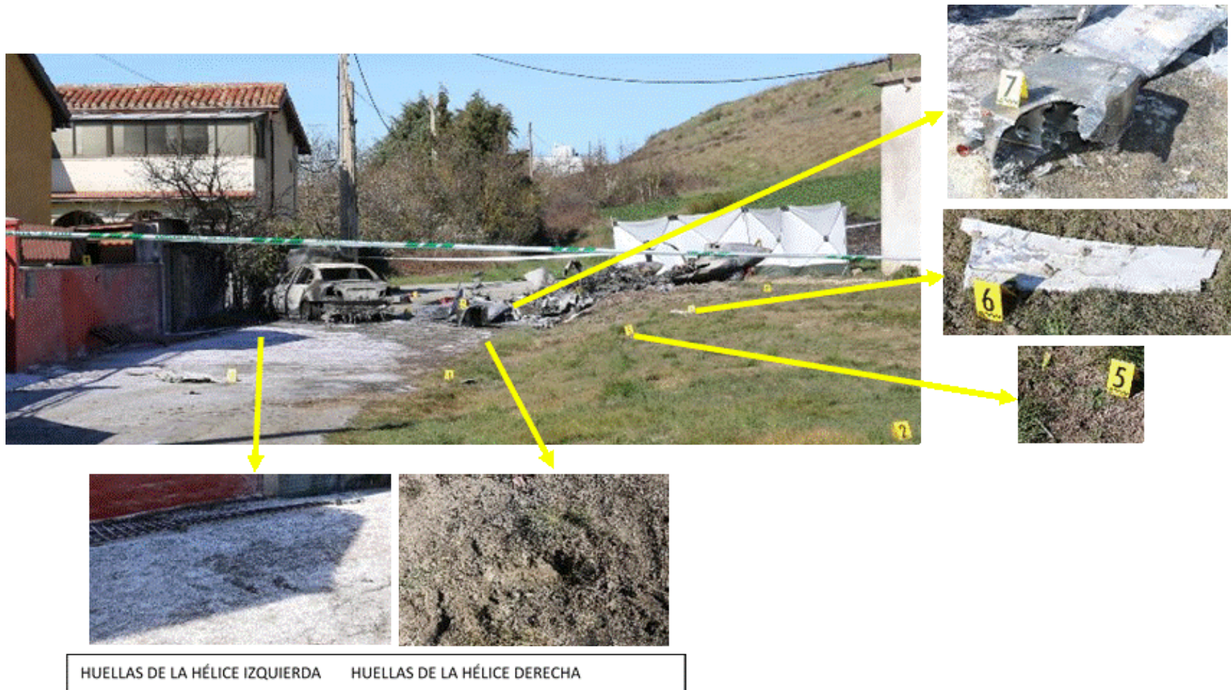
Ilustración 5: Detalle de las huellas de las hélices y, a la derecha, timón de profundidad derecho (número 6)
