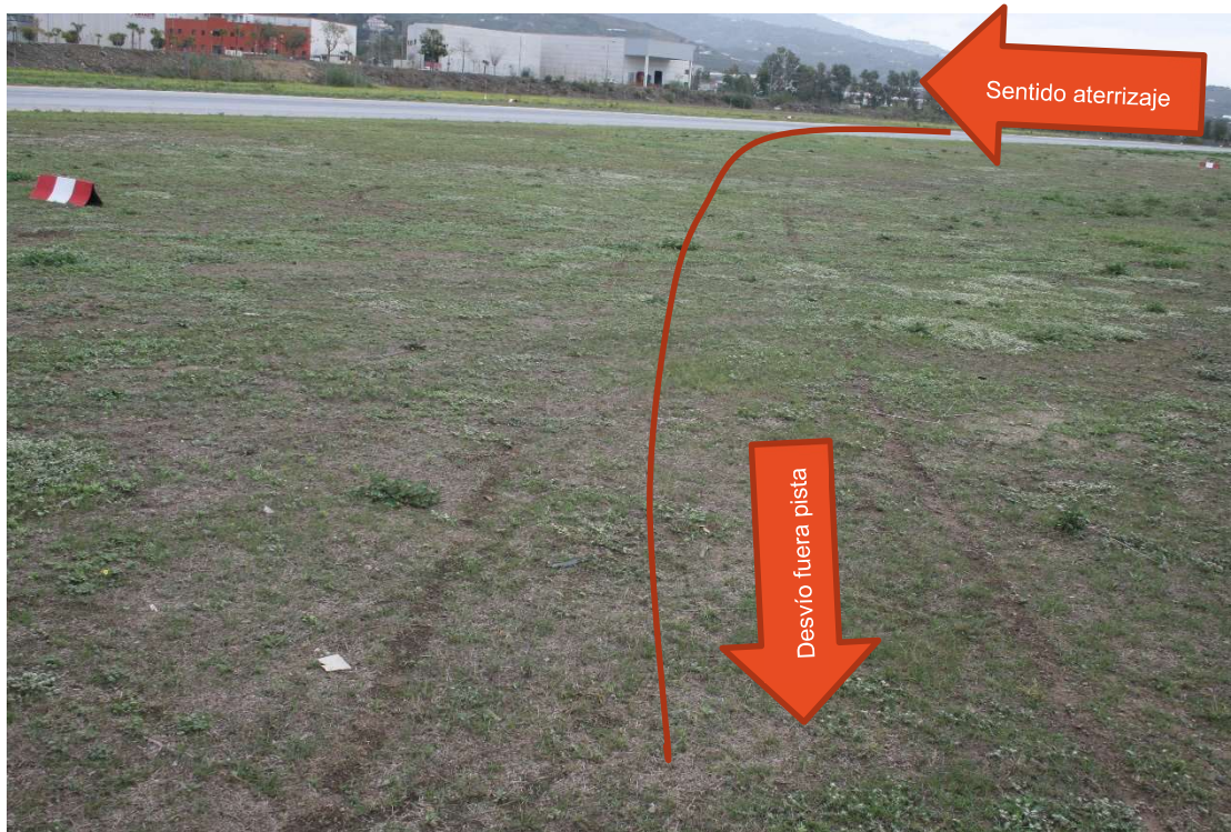
Ilustración 5 Marcas fuera de pista del tren principal
