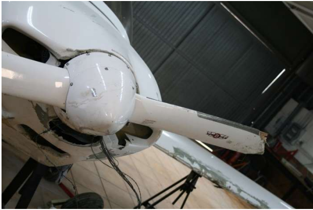
Ilustración 10 Punta de hélice fracturada
