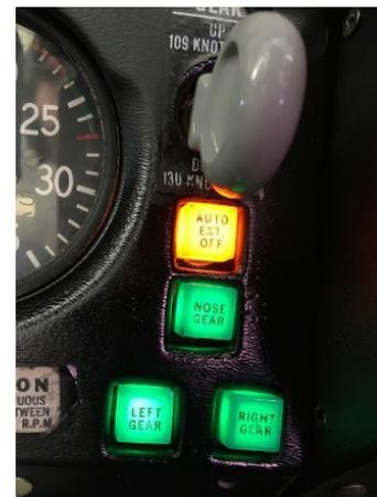
Fotografía 3. Luces de posición del tren
