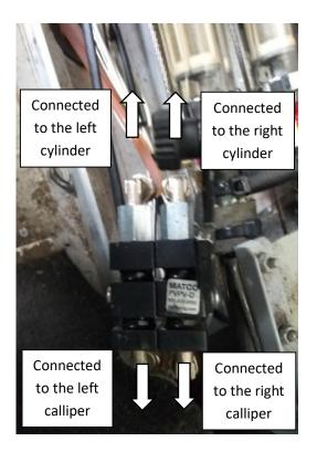
FIG. 8 OVERVIEW OF THE PARKING BRAKE VALVE INSTALLATION
