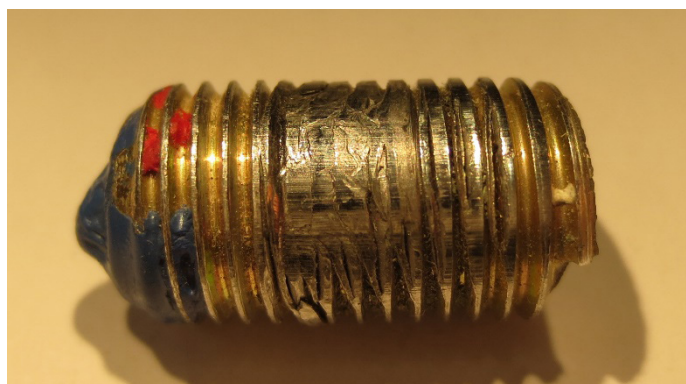
Figura 7. Fotografía del fragmento cizallado del tornillo interior (MS200006-27)
