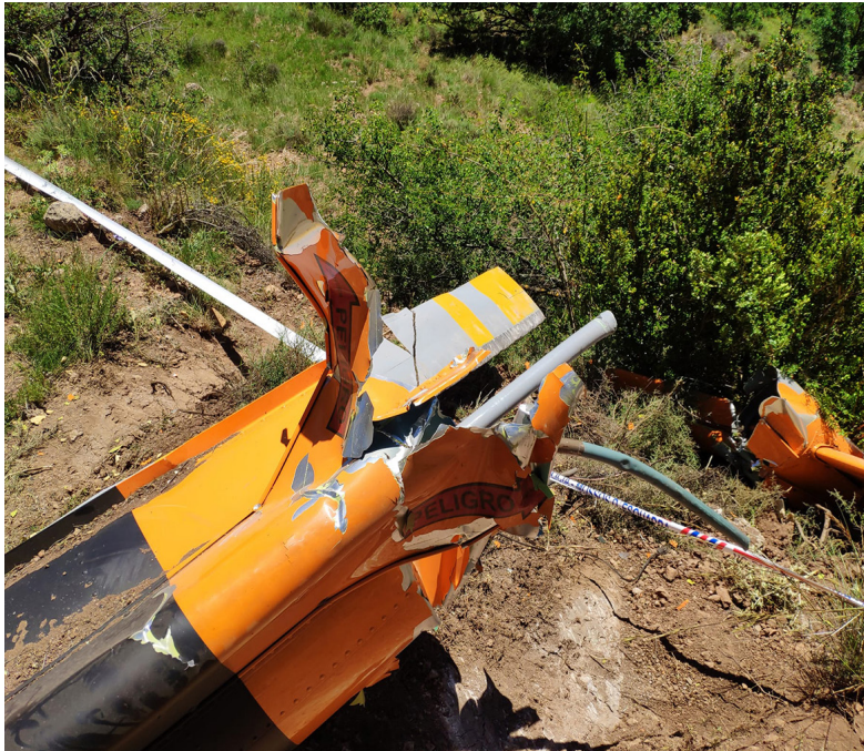
Figura 16. Cono de cola y estabilizador horizontal
