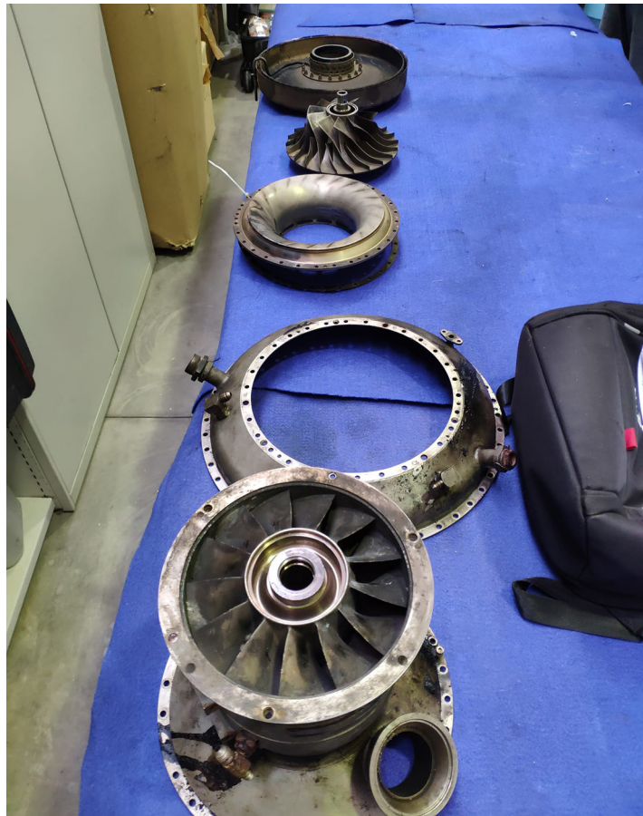
Figura 21. Despiece durante la revisión
