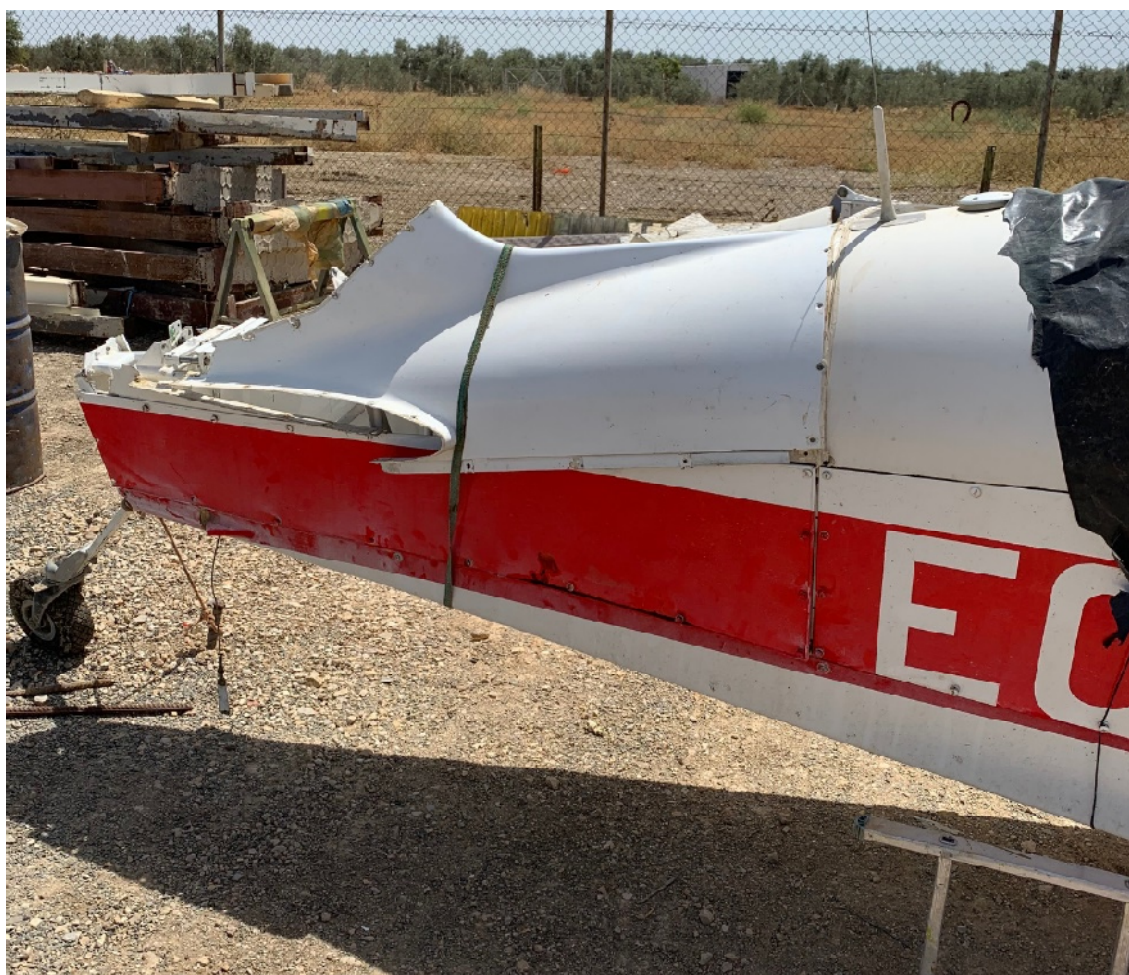
Figura 7: estado final del empenaje de cola tras arrancarse el estabilizador vertical.
