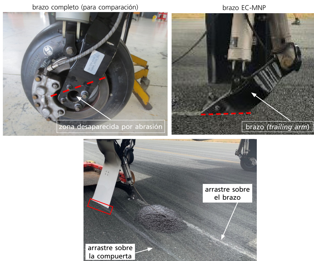
Figura 8. Pérdida de material por abrasión en compuerta y brazo
