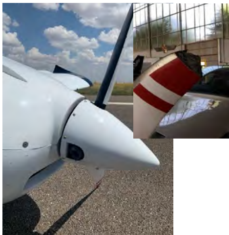
Fotografía 5. Daños en hélice
