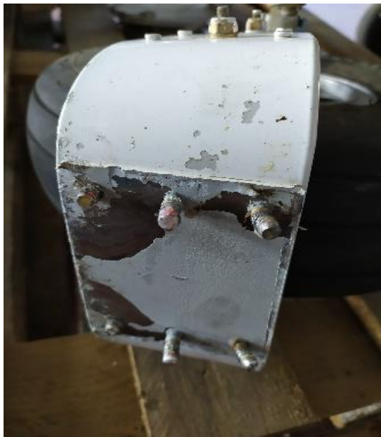
Fotografía 15. Zona de anclaje de la horquilla y la pata del tren de morro
