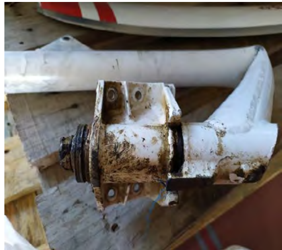
Fotografía 16. Zona inferior de la pata del tren de morro arrastrada por la pista
