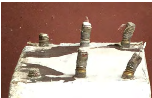
Fotografía 13. Tornillos de anclaje de la horquilla a la pata del tren de morro después del suceso
