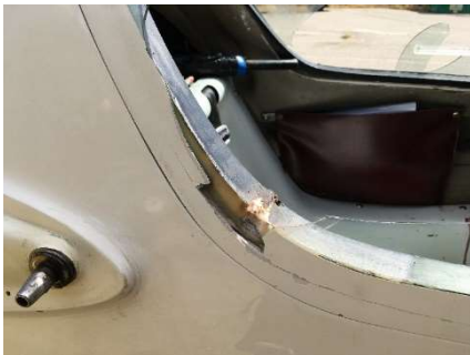
Fotografía 13. Daño en lateral de cabina trasera
