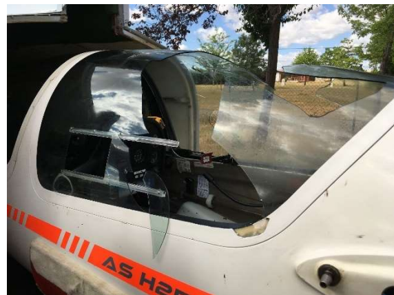
Fotografía 18. Rotura de cubierta de cabina trasera
