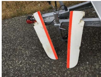
Fotografía 14. Compuertas de tren principal
