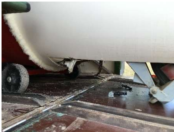
Fotografía 16. Daños en tren principal
