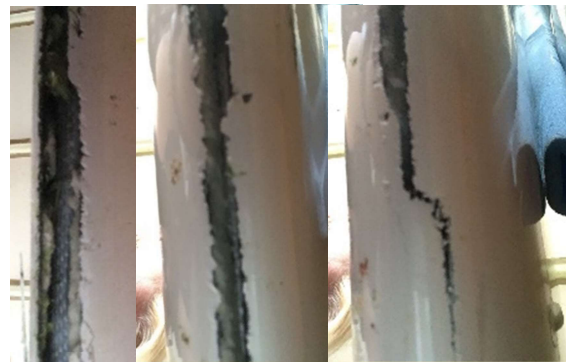
Fotografía 17. Delaminaciones de borde de ataque
