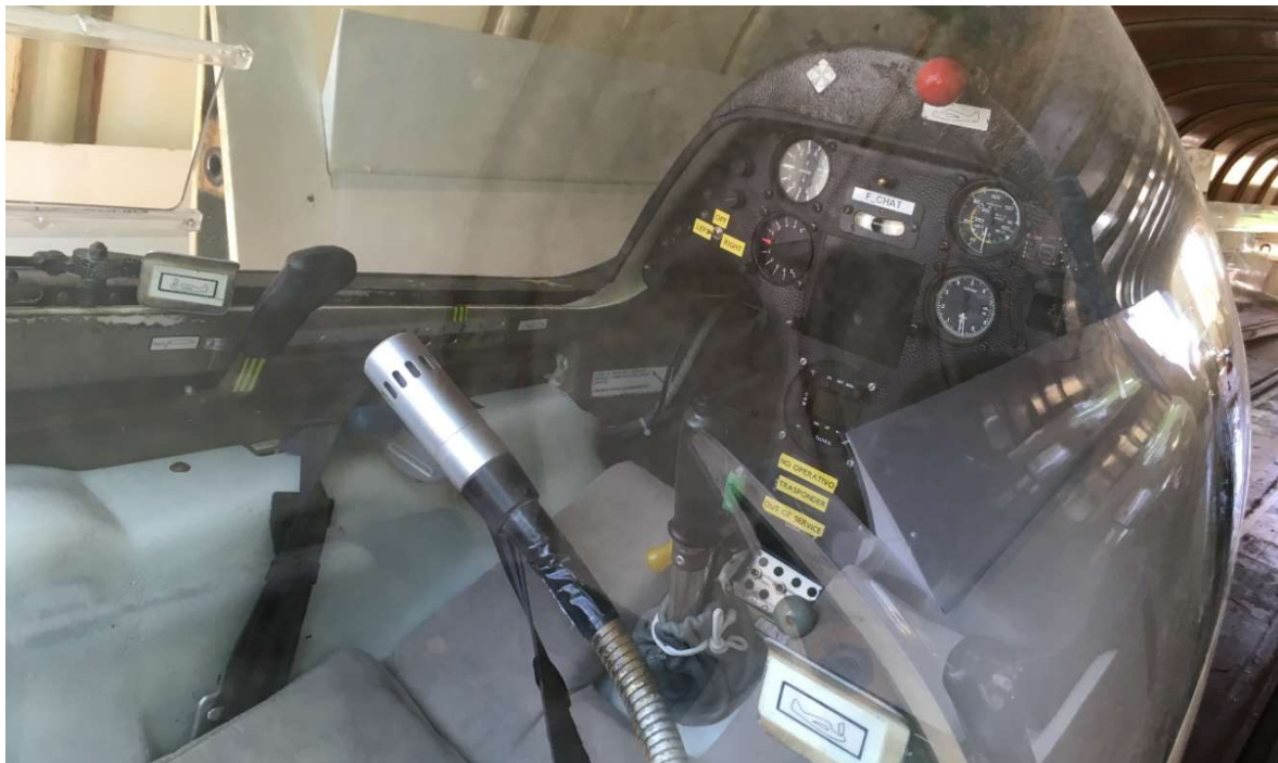
Fotografía 2. Panel de instrumentos delantero en la posición del piloto al mando
