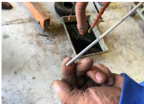
Fotografía 17: Varilla de aceite y aceite remanente del motor en cubeta
