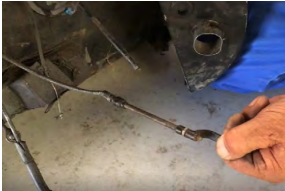
Fotografía 12. Cable de actuación del mando de mezcla en posición de mezcla pobre
