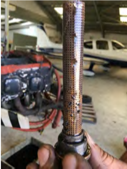
Fotografía 19: Filtro de aceite con partículas metálicas
