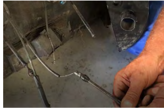
Fotografía 13. Cable de actuación del mando de mezcla en posición de mezcla rica
