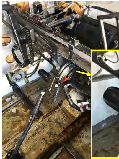
Fotografía 11. Mando de mezcla en la cabina de vuelo y detalle.
