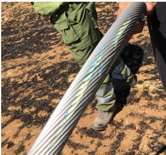
Fotografía 17. Transferencias de color al cable del impacto
