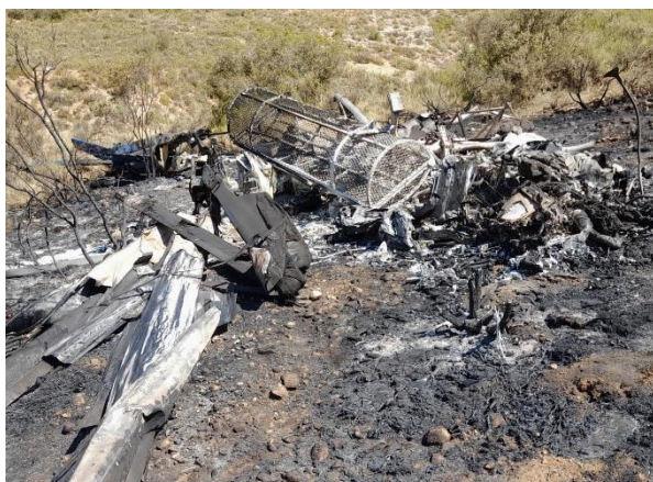
Fotografía 9. Motor fundido, canasta porta-helibalde y palas del rotor principal
