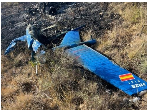
Fotografía 7. Empenaje y sección del puro de cola
