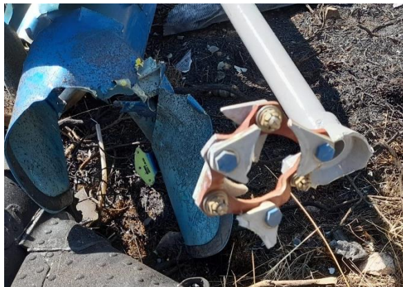
Fotografía 13 izquierda. Rotura anclaje del rotor de cola a puro de cola.
