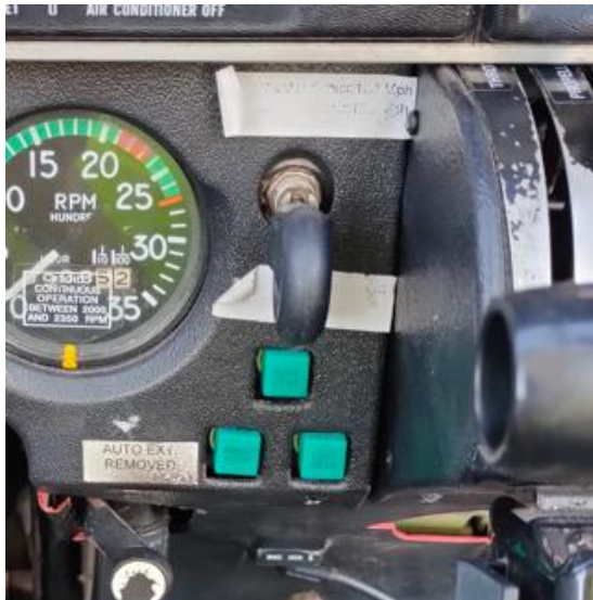
Ilustración 3: Detalle de las tres luces verdes y del selector del tren de aterrizaje
