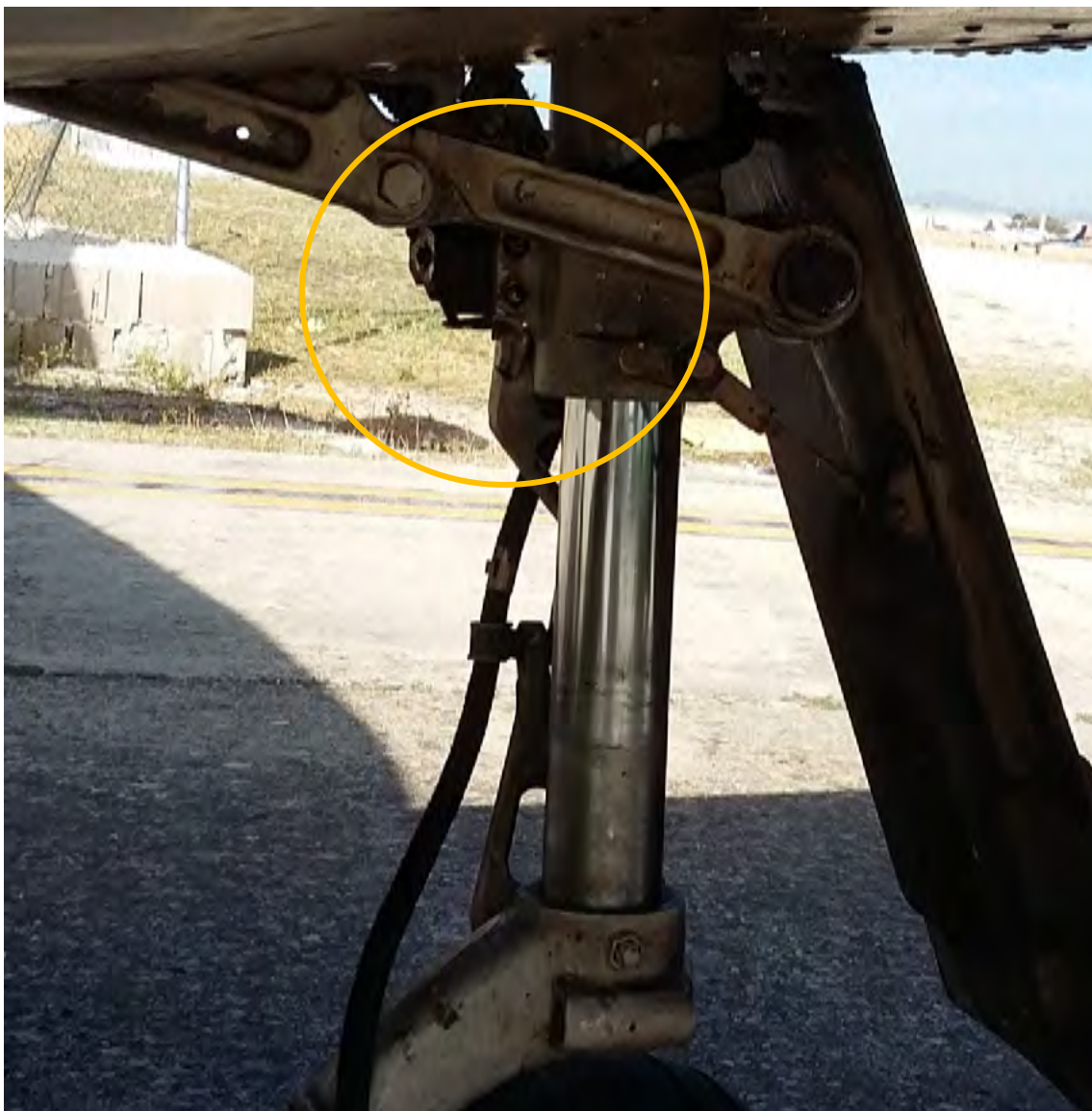
Ilustración 6: Detalle del tren principal de la aeronave accidentada
