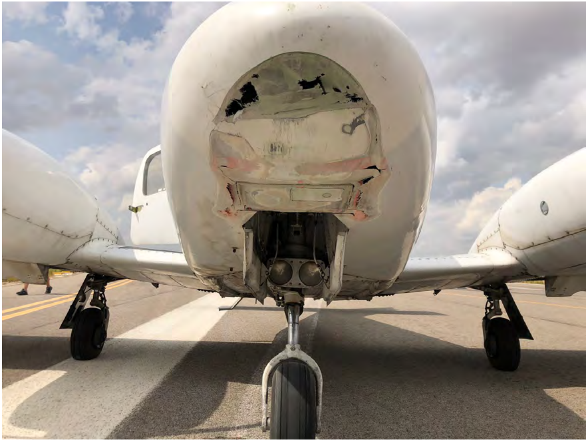
Ilustración 1: Detalle de los daños en el fuselaje
