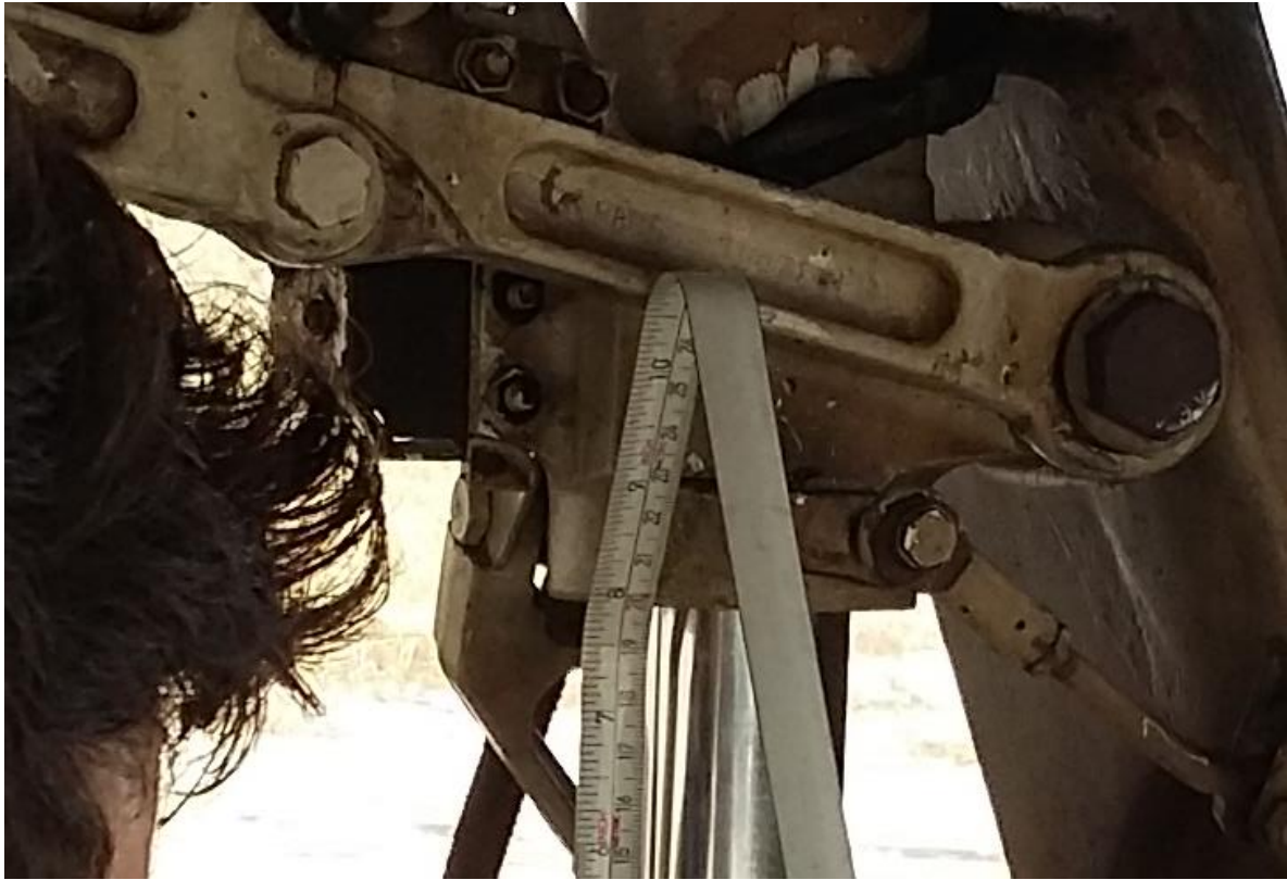
Ilustración 8: Detalle del interruptor squat con un ajuste superior a ocho pulgadas
