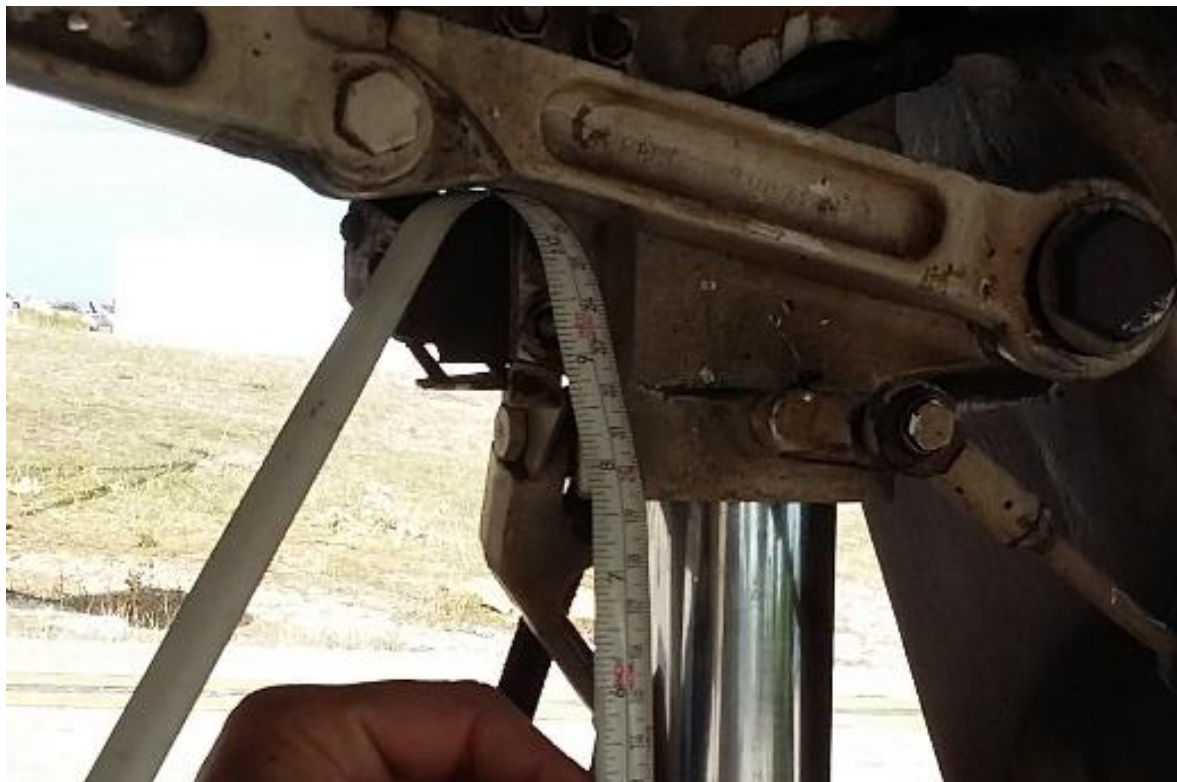
Ilustración 7: Detalle del ajuste del interruptor squat
