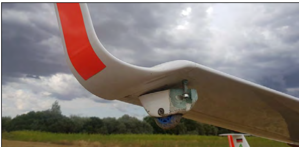
Ilustración 9: Daños en la rueda de la punta del plano derecho
