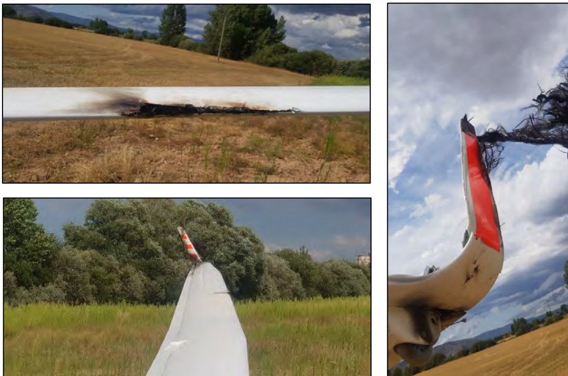
Ilustración 8: Vestigios del enganche con el cable y el arco voltaico provocado
