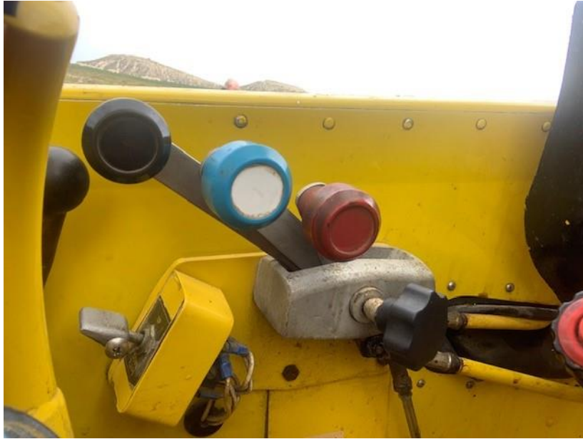
Fig. 3: Vista lateral del conjunto de mandos del motor: mando de gases (negro), de paso (azul), de mezcla (rojo) y el tornillo de fricción (negro con empuñadura ondulada).
