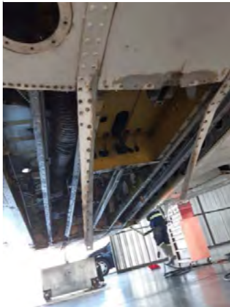
Fotografía 5: Alojamiento del tren de morro
