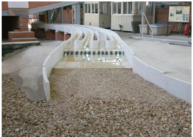
► Modelos físicos de presas a escala reducida.
