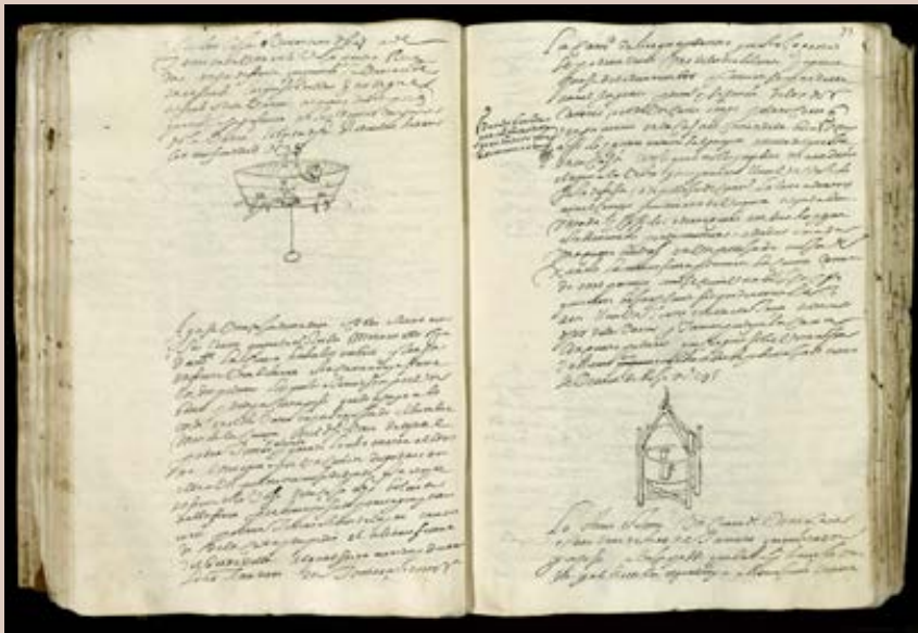
Patentes de 1606 de Jerónimo de Ayanz, de barca para sumergirse y campana para bucear. Archivo General de Simancas.
