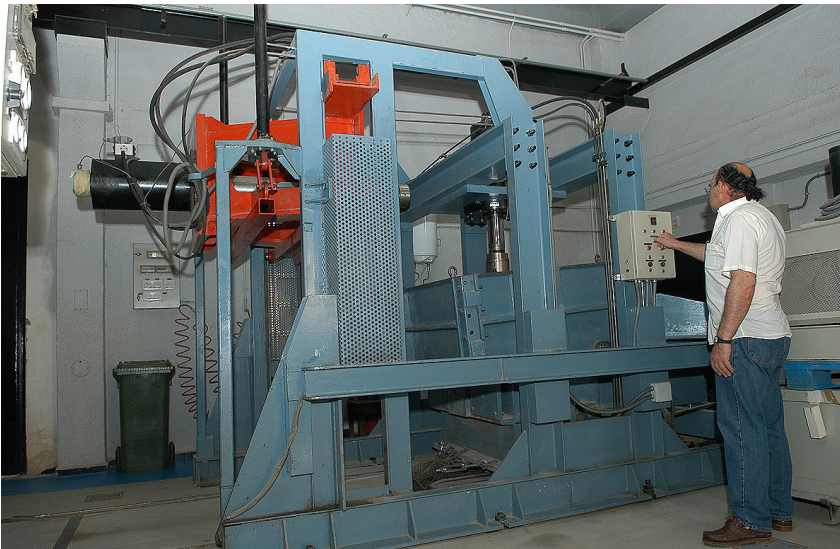
Caja de corte de metro cúbico del laboratorio de Geotecnia.
