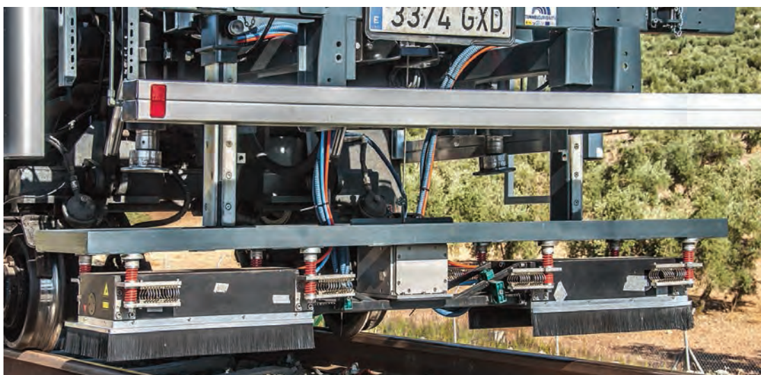
►Detalle del equipamiento y los sensores en la parte inferior del vehículo.
