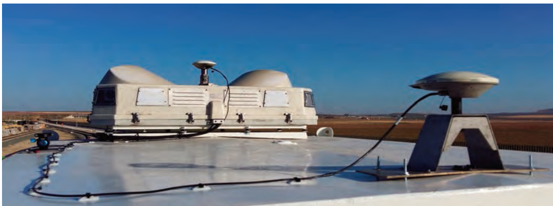
►Detalle de la cámara panorámica 360° instalada en la parte superior del prototipo.
