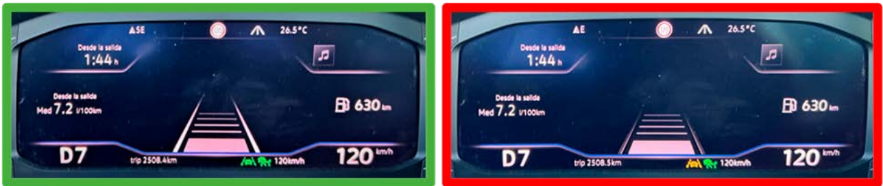
Figura 1. Representación esquemática en un cuadro digital de coche de la conexión (izquierda) y la desconexión (derecha) de un sistema de conducción automatizada. (Fuente: propia).
